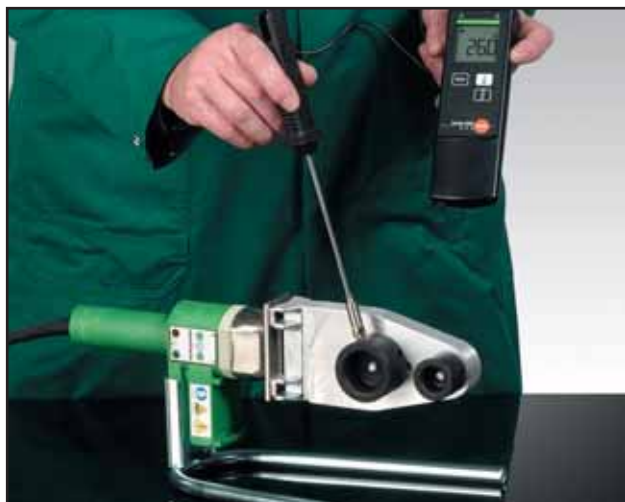
Kontrola temperature digitalnim kontaktnim termometrom
