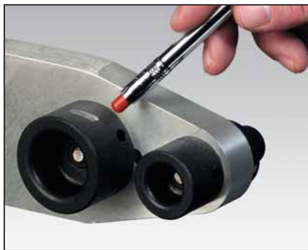
Kontrola temperature potezom termičke olovke
